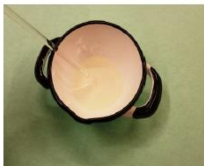
Rycina 2. Witepsol H15 po stopieniu w parownicy (zdj. wykonane przez autorów).
